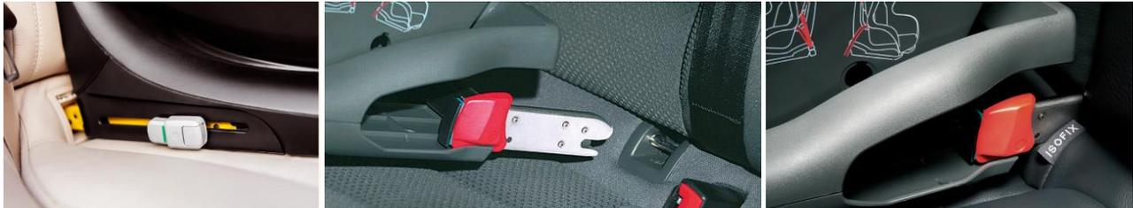
Figure 6. Le système d'ancrage ISOFIX
